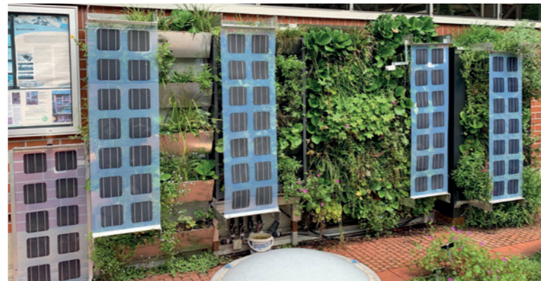
Abbildung 5: Versuchsaufbau der VertiKKA an der HfWU in Nürtingen mit unterschiedlichen Begrünungssystemen und vorgehängten Photovoltaikmodulen zur Untersuchung der Pflanzvitalität über die Vegetationsperiode und der Interaktion Pflanze und Photovoltaikmodul (Bild: HfWU Nürtingen)
